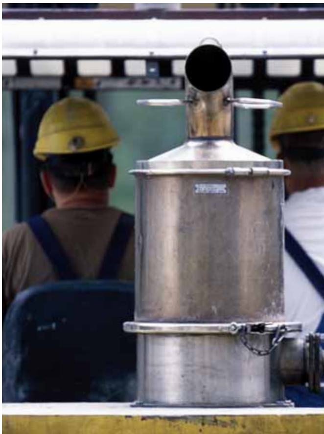
Baumaschine mit Partikelfilter
